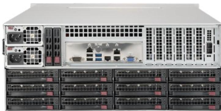
Хранилище pool/6 представляет собой GlusterFS Distributed Volume [3] кластер с использованием локальных файловых систем XFS и программных RAID-10 массивов на узлах.
